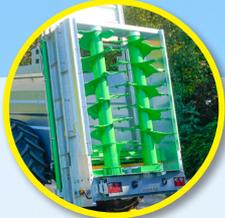
Hérissons verticaux de grand diamètre avec pales escamotables et crocs en HARDOX 450
