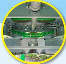
Timon en « V » réglable avec suspension à lames paraboliques
